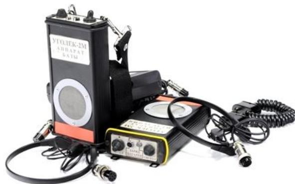
**Рис. 4.** Аппаратура проводной связи «Уголек-2М»
